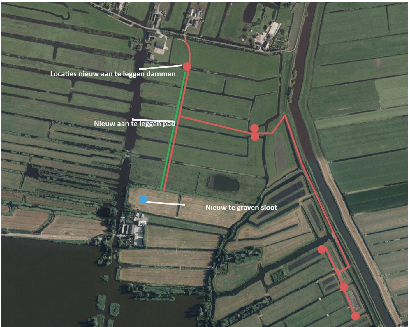
Aanvoerroute aanleg dammen, pad en te graven sloot. (Bron: Staatsbosbeheer)
